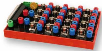
Als Orientierungshilfe wurden die Anschlüsse auf der Platine mit den zugehörigen Pinnummern des D-Sub37 Steckers gekennzeichnet.
