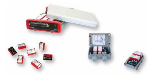
Eine Vielfalt unterschiedlicher Miniaturmessverstärker der MAL-Serie mit oder ohne galvanische Trennung ist erhältlich. Verschiedene BP-Trägerplatinen von bmcm in unterschiedlicher Größe und Bauform ermöglichen den komfortablen Anschluss zum Messsystem und die Speisung des Verstärkers. Die MAL-Messumformer können in beliebiger Kombination auf die Trägerplatinen gesteckt werden.
