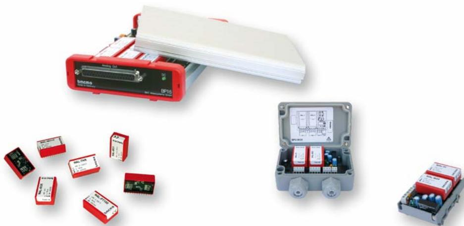
Eine Vielfalt unterschiedlicher Miniaturmessverstärker der MAL-Serie mit oder ohne galvanische Trennung ist erhältlich. Verschiedene BP-Trägerplatten von bmcm in unterschiedlicher Größe und Bauform ermöglichen den komfortablen Anschluss zum Messsystem und die Speisung des Verstärkers. Die MAL-Messumformer können in beliebiger Kombination auf die Trägerplatten gesteckt werden.
