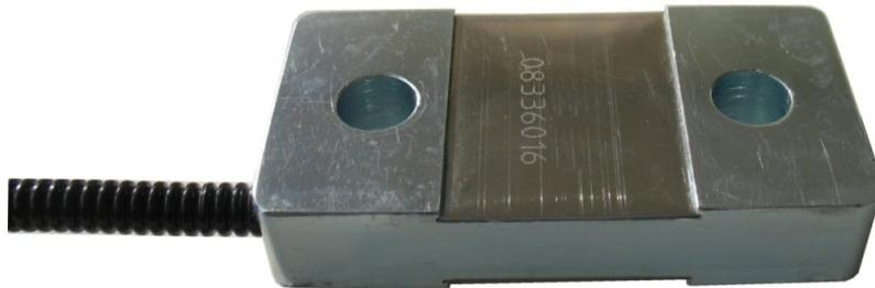
Der Dehnungsaufnehmer DA70 eignet sich zur die Dehnungs- und Kraftmessung an Maschinenelementen in rauher Umgebung. Die Installation erfolgt durch Anschrauben des Aufnehmers mit 2 Schrauben M10 auf einer ebenen Werkstoffoberfläche. Das Anschlusskabel ist wahlweise als PUR Kabel ausgeführt oder mit einem zusätzlichen Welschlauch geschützt.
