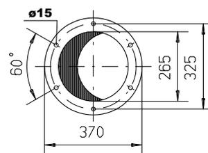
**AJN 034 RF bis /upto/ jusqu'à AJN 084 SL RF**
