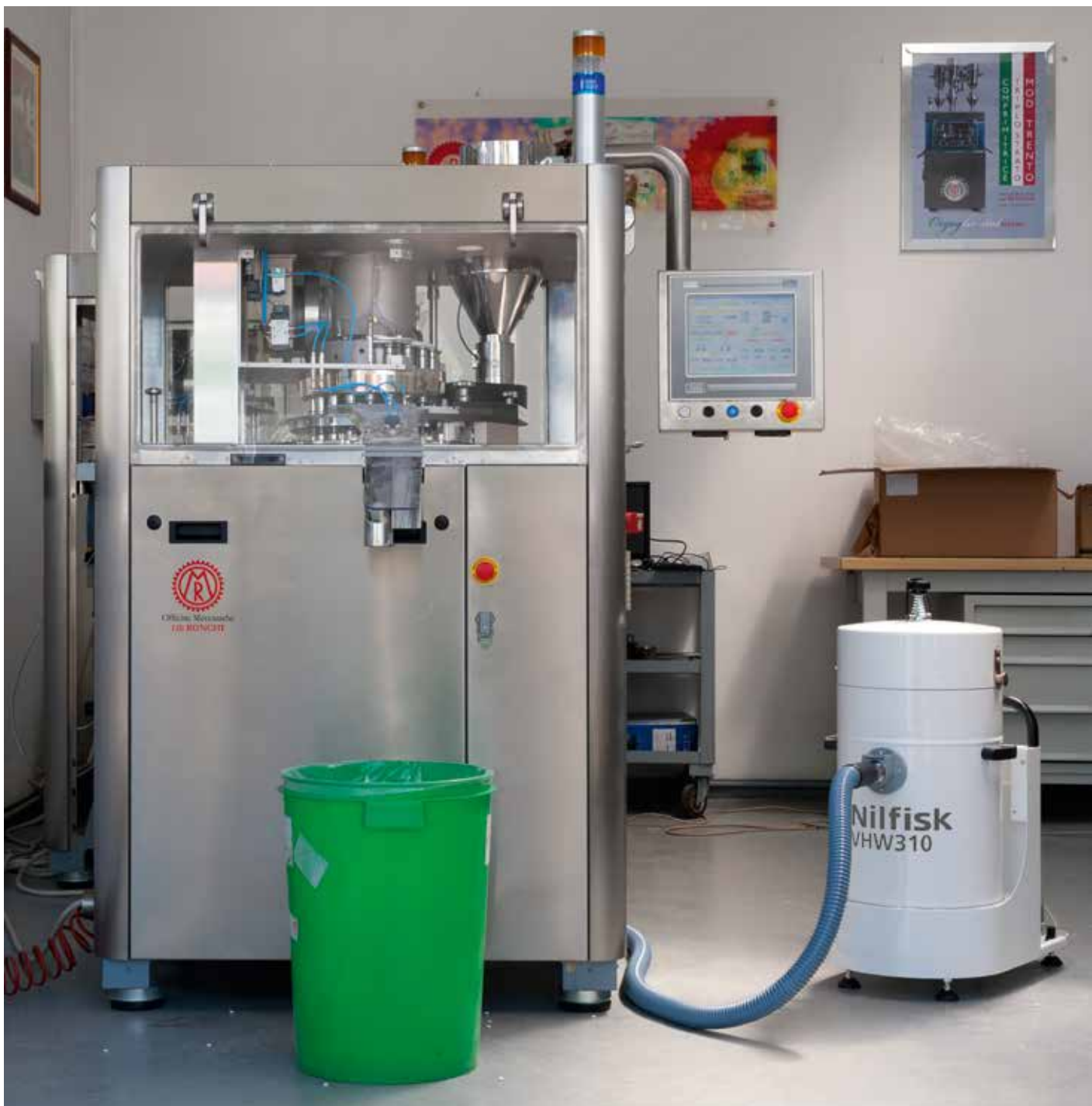
VASTE INDUSTRIËLE STOFZUIGER BIJ EEN TABLETTEERMACHINE
