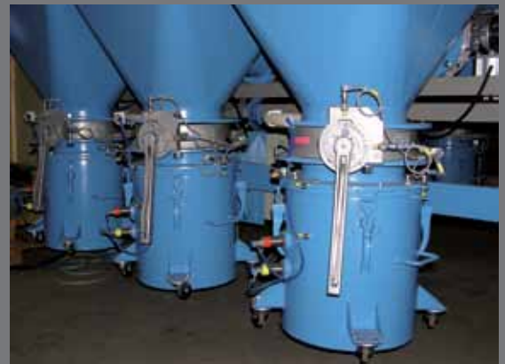
Staubsaammeltopf mit Kontaktsensoren
